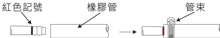
(2) 使用稀釋之中性清潔劑塗佈在接口處再將瓦斯氣源打開，如有氣泡產生即代表漏氣，請關閉瓦斯氣源，重複前一步驟進行確認。
